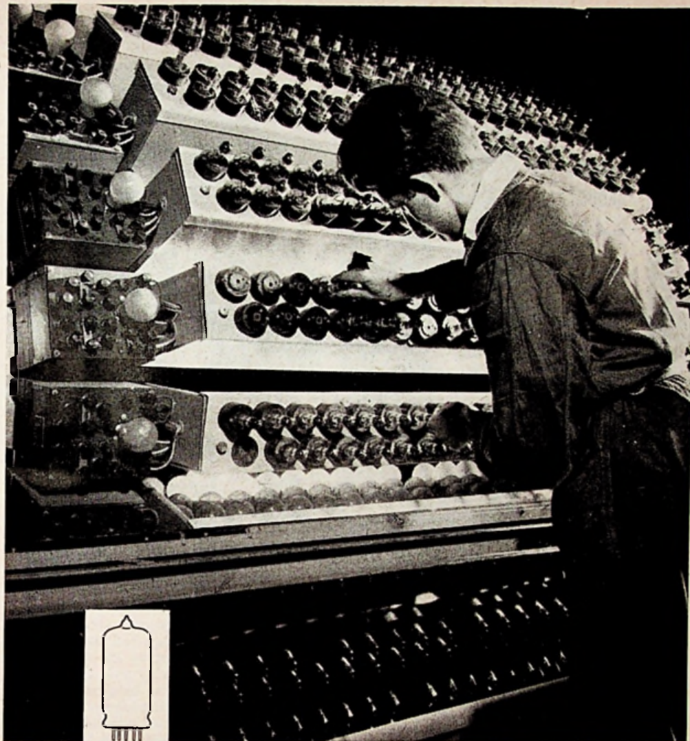
Het formeren van elektronenbuizen
